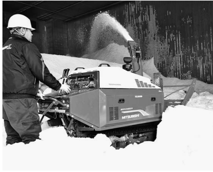
▲除雪機で天井近くまで積み上げられていく雪の搬入作業
